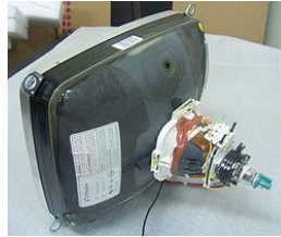
شكل 1-5 شاشة تلفزيون 14 انج مبين فيها صورة ملفات الانحراف الكهرومغناطيسي
